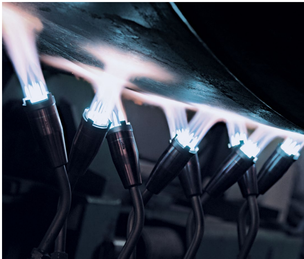
LINDOFLAMM LF-H-8x2D, en typisk manuell förvärmningsbrännare
